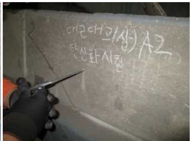
콘크리트 탄산화시험(탄산화 깊이측정)
